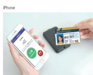
iPhoneとカードリーダーをBluetooth接続し、設置した例
